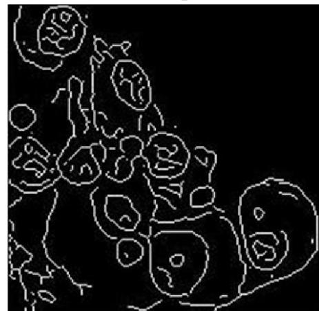
Détection de contours par Canny
